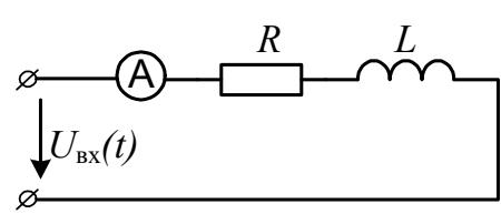
3) какое активное сопротивление  $R$  необходимо подключить последовательно к данной идеальной катушке индуктивности  $L$  для того, чтобы при увеличении частоты питающего напряжения в 1,2 раза показания амперметра осталось неизменным при том же действующем значении входного напряжения?
